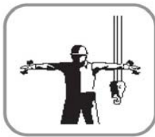
PARO DE EMERGENCIA
